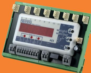
Après le calibrage des capteurs de charge de câble LS-light, l'unité d'évaluation AE8 indique la charge dans la cabine.
